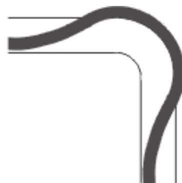
přechod kabelu přes ohyb
