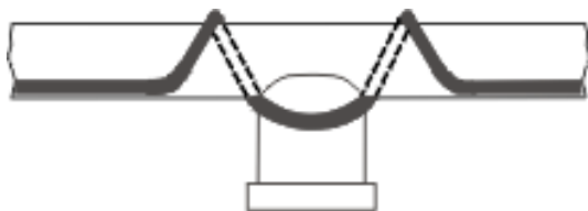
přechod kabelu přes podpěru
